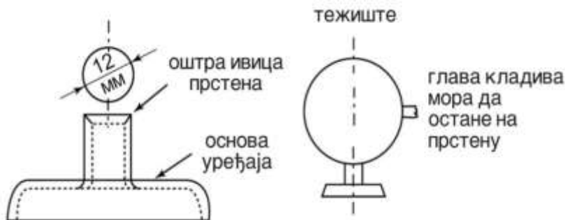
Скица 20. Уређај за контролу тежишта главе кладива
